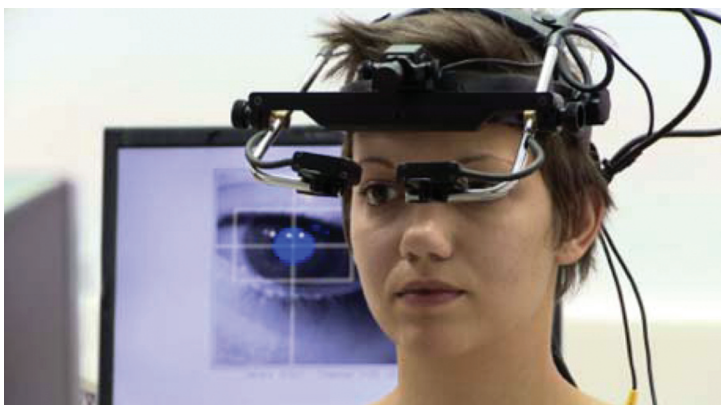
Εικόνα 5: Ανιχνευτής οφθαλμικών κινήσεων για καταγραφή απόδοσης ανάγνωσης.
